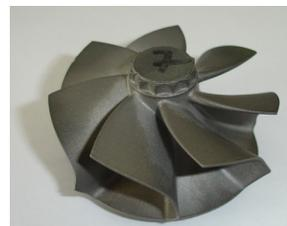
innovative Gießverfahren in Kombination mit einer Legierungs- sowie Mikrostrukturoptimierung die mechanischen Eigenschaften gezielt verbessert werden und Turbinenräder für den Abgasturbolader hergestellt werden, die zu einem deutlich
