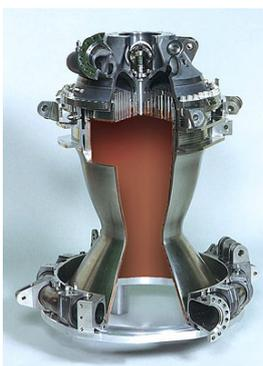
und letztendlich zum Versagen. Ermüdungserscheinungen (Kriechen, Low Cycle Fatigue) sowie thermochemische Effekte (Oxidations- / Reduktionsreaktionen) schränken die Lebensdauer der Brennkammerheißgaswand zusätzlich ein.
