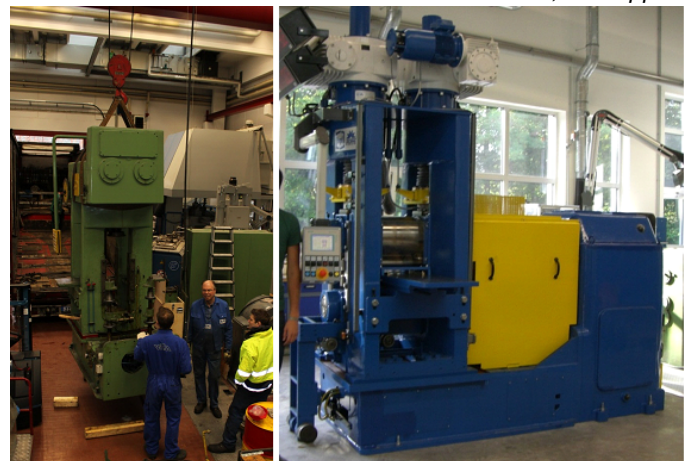
Links: Demontage der Walze vor der Modernisierung. Rechts: Die ARB-Walze bei WW I nach der Modernisierung
