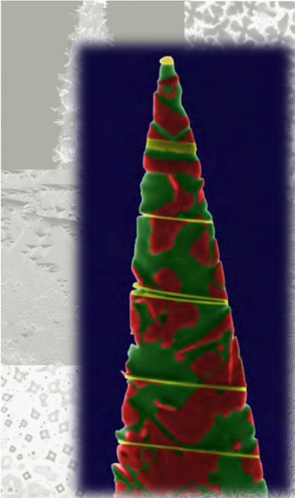
Atomsondenspitze einer  $\text{Co}_{90}\text{Al}_{10}\text{W}_2\text{Pd}$ -
