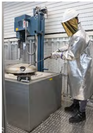
M. Kohlhepp beim Gießen der Aluminiumlegierungen.
